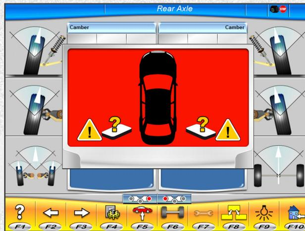
Con las teclas PAG\_UP o PAG\_DOWN en el teclado activar la función de seguimiento automático y lanzar la búsqueda de los targets hacia arriba o hacia abajo.
